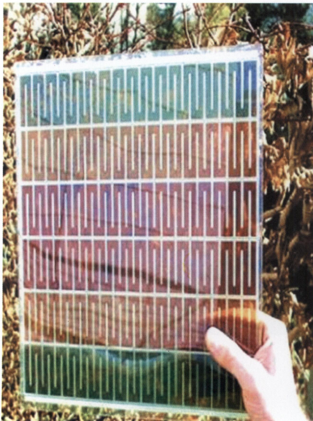
รูปที่ 3.5 เซลล์แสงอาทิตย์ชนิด Dye Sensitized
