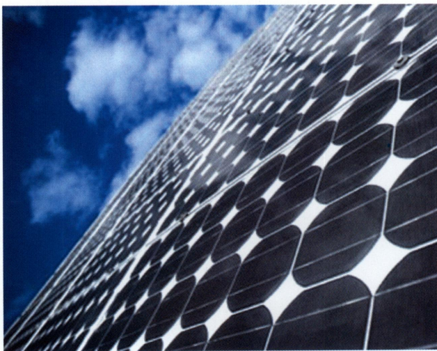
รูปที่ 3.1 เซลล์แสงอาทิตย์ชนิด Single-Crystalline Silicon
