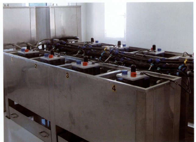
รูปที่ 3.14 การทดสอบค่าความจุแบตเตอรี่
