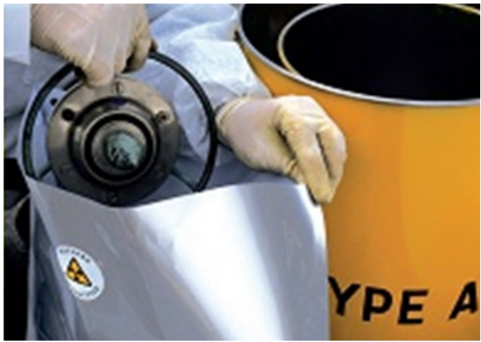
รูปที่ 3 ขั้นตอนการจัดการสายล่อฟ้าที่มีวัสดุกัมมันตรังสีหลังเลิกใช้งานแล้ว
