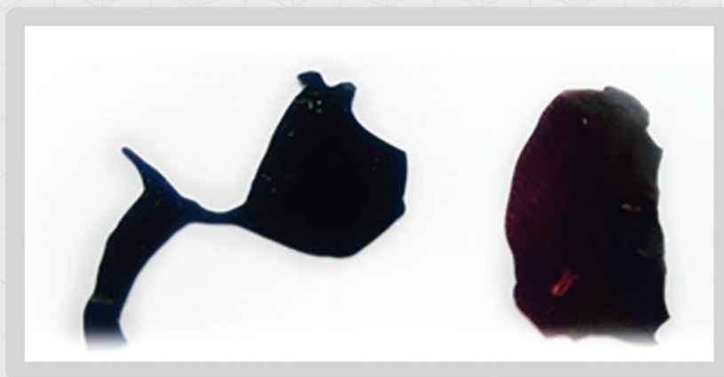
รูปที่ 1 ภาพตัวอย่างของแก้วระบบลิเทียมวานาเดตบอเรตที่เตรียมได้
