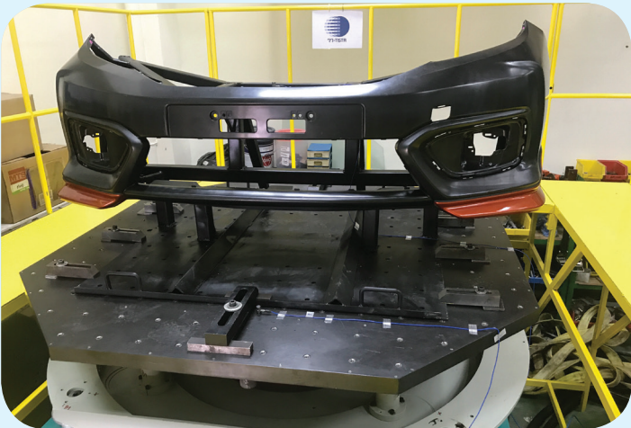
การทดสอบเพื่อพัฒนาปรับปรุงความแข็งแรงและอายุการใช้งานของชิ้นส่วนรถยนต์ที่เกิดจากการสั่นสะเทือน
