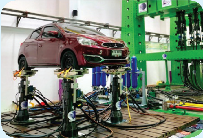
การทดสอบเพื่อพัฒนาปรับปรุงความแข็งแรงและอายุการใช้งานระบบช่วงล่าง (Suspension) รถยนต์ จากการจำลองสภาพถนนที่ใช้งานจริง
