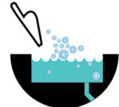
เติมคลอรีนที่บ่อพักน้ำสุดท้าย ก่อนปล่อยน้ำออกสู่สาธารณะ
