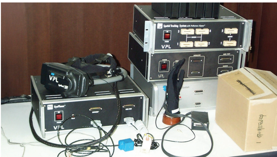
ถุงมือตรวจจับการเคลื่อนไหว DataGlove กับแว่นตาสวมศีรษะแสดงผลภาพโลกเสมือน EyePhone HMD ที่มาภาพ : Dave Pape, Public Domain via Wikimedia Commons
